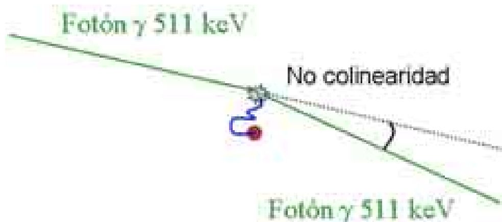
Figura 14- Esquema de aniquilación con representación del efecto de la no-colinearidad.
